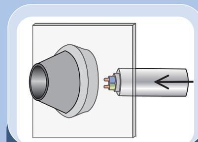
Lèvre déformable s'adaptant à une épaisseur de paroi de 1 à 4 mm.
