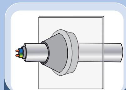
Forme permettant le passage de câbles de différents diamètres.
