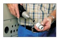
**DURCHFÜHREN** PLIO-SPEED mit der Montagezange durch das Durchgangsloch schieben und pressen
